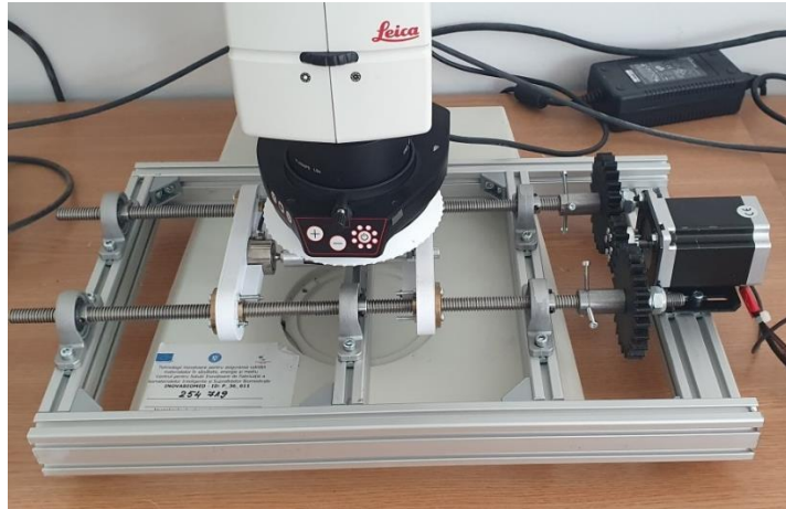
Fig. 1.2. Sistemul de încercare la tracțiune folosit împreună cu sistemul Dantec \mu DIC.
