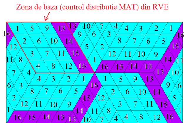
Fig. 3.7. Regula de numerotare a pixelilor din RVE. Se observă că un pixel din zona de bază se regăsește 3 \times 2 = 6 ori în RVE.
