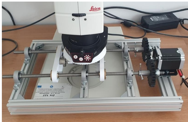
Fig. 4.1. Noul cadru de aluminiu al sistemului de testare.
