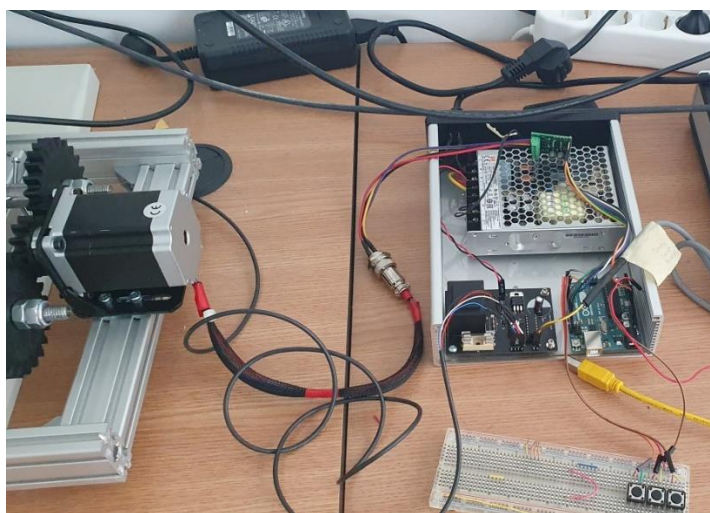
Fig. 4.2. Cutia cu componentele de comandă a echipamentului de testat.
